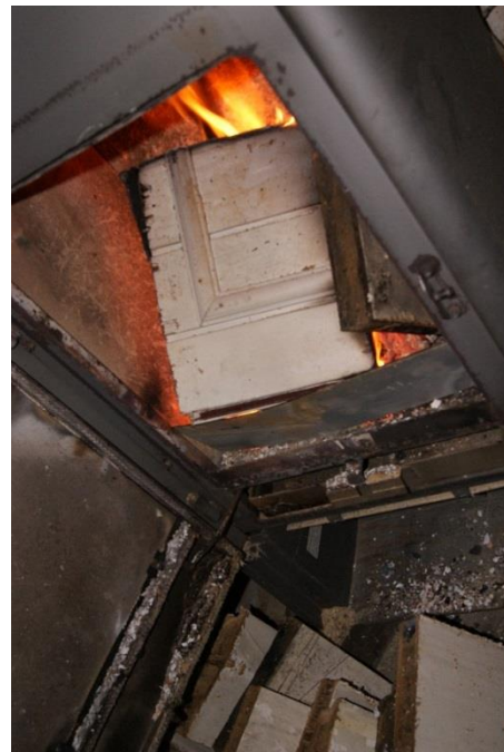
Bild 2: Reste einer Tür mit bleihaltigem Anstrich
