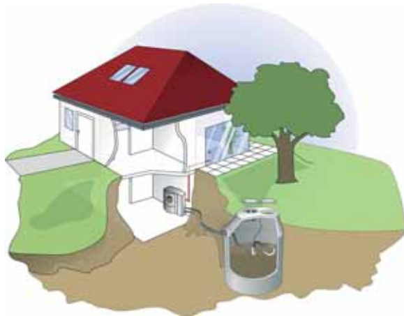
Beispiel für einen Pelletlagertank außerhalb des Hauses. Die Pelletförderung erfolgt durch Saugaustragung. Grafik: Mall GmbH, Donaueschingen
