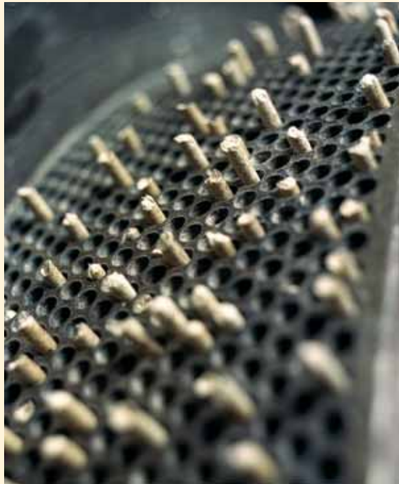
Ringmatrize für 6 mm Holzpellets Quelle: Westerwälder Holzpellets, Langenbach
