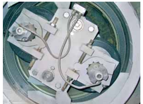
Robuste Stahlwalzen (Koller) pressen die Holzspäne durch die Matrice Quelle: Bühler AG, Uzwil, Schweiz
