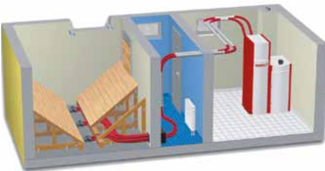
Pelletzentralheizung mit Saugförderung
